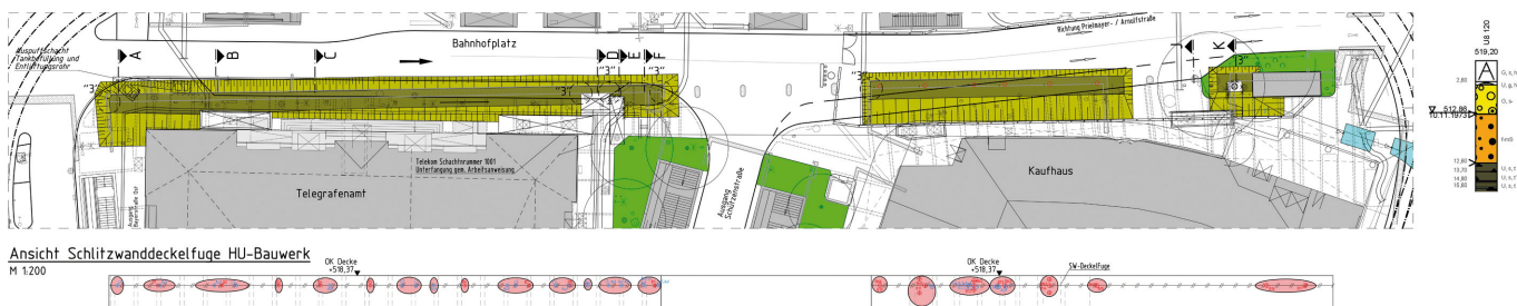
Bild 12. Dokumentation der Schäden an der Ostseite
